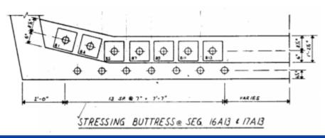
BOTTOM SLAB TENDON LAYOUT - MID SPAN
